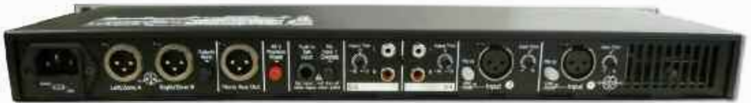
Auf der Rückseite finden sich die meisten Anschlüsse, die für die feste Installation benötigt werden – der Betriebssicherheit dienen die kleinen Gain Trimpotentiometer auf der Rückseite, die nach dem Einbau in ein Rack nur noch schwer zugänglich sind und deshalb vorher eingestellt werden sollten
